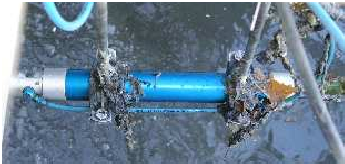
Abbildung 76: Verzopfungen auf den Halterungsstangen des Spektrometers in Fließrichtung nach dem optischen Pfad
