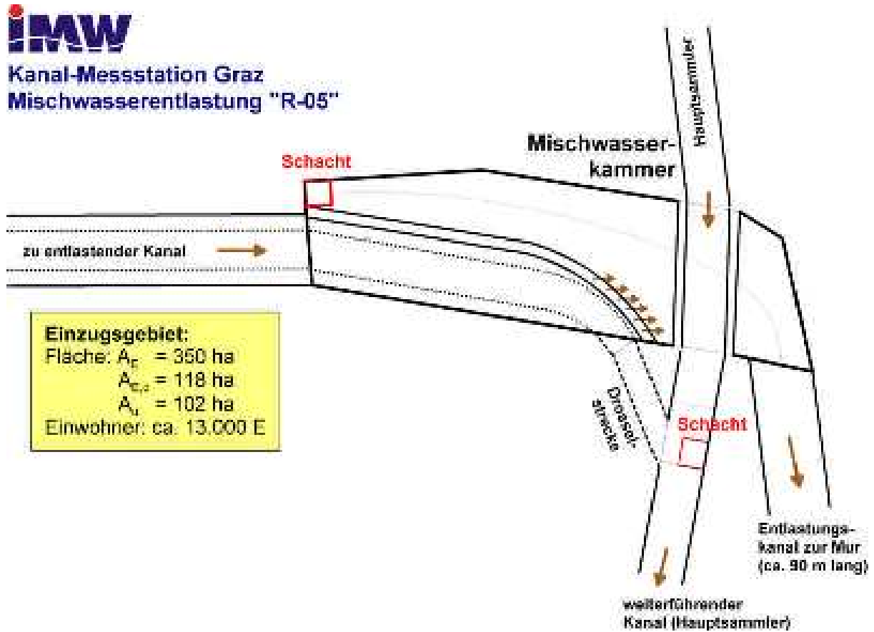
Abbildung 24: Die Geometrie des Mischwasserentlastungsbauwerkes „R-05“ in Graz
