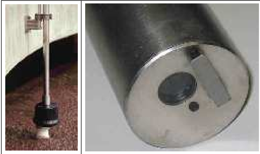
Abbildung 6: Schlammvolumensonde im Belebungsbecken (links) und Detailansicht 90°-Streulichtsonde zur TS-Messung (rechts) (Quelle: LANGE GmbH)
