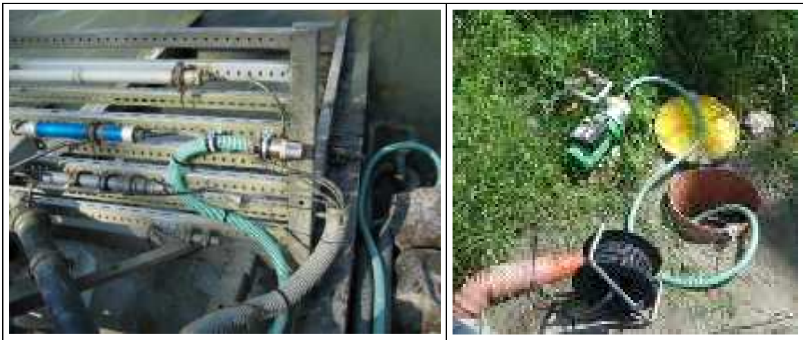
Abbildung 65: Montage eines Probenahmeschlauchs zur punktgenauen Entnahme von Donauwasser bei erhöhtem Wasserspiegel
