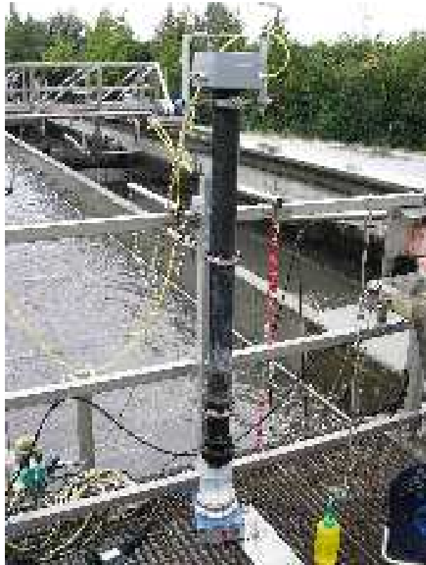
Abbildung 74: Zweipunktkalibrierung einer ISE-Sonde mit Standardlösungen
