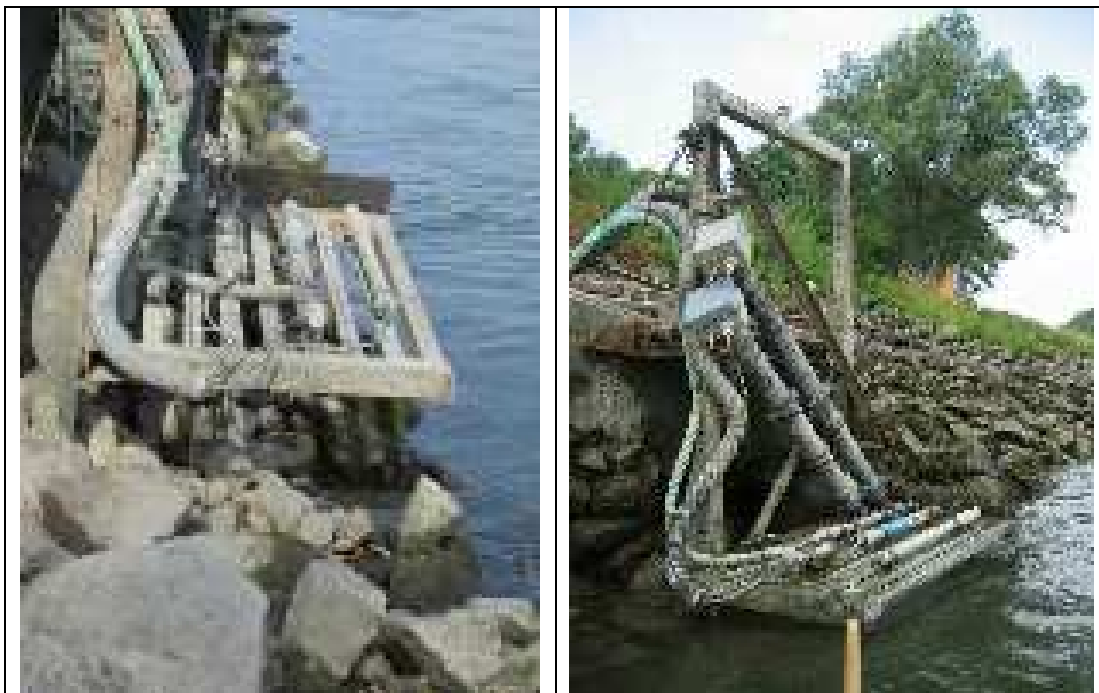
Abbildung 70: Sensoren hängen durch einen zu geringen Wasserspiegel der Donau in der Luft. Dies wurde besonders oft im trockenen Jahr 2003 beobachtet.
