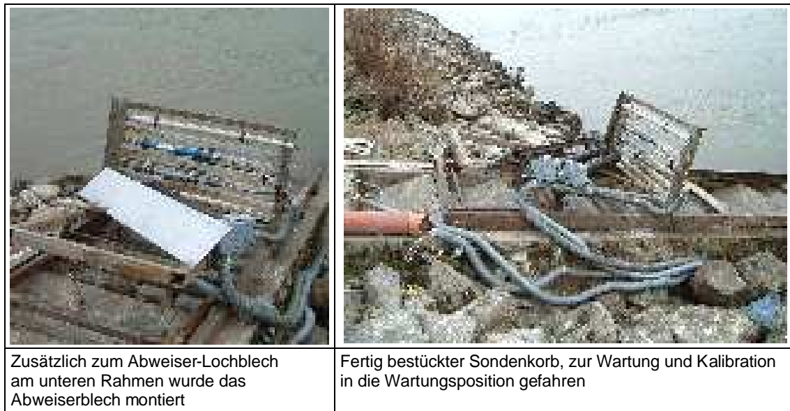
Abbildung 49: Sondenkorb in Wartungsposition mit Panzerschlauch
