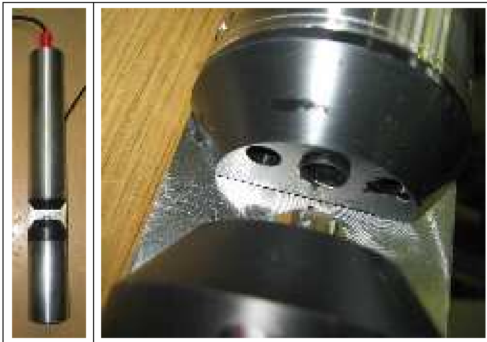
Abbildung 9: Beispiel eines tauchfähigen Spektrometers (TRIOS GmbH) und Detailbild des optischen Pfades
