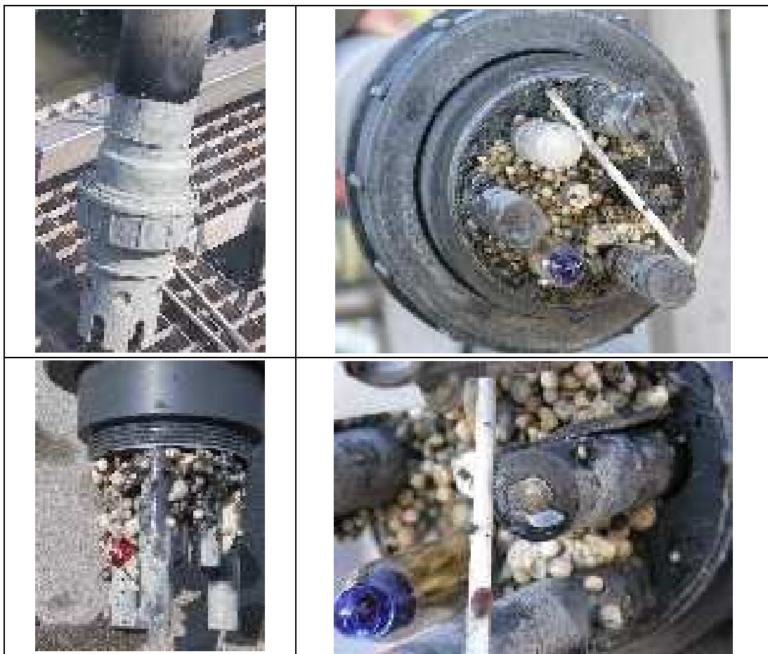
Abbildung 73: Verschmutzung der ISE-Sonde im praktischen Betrieb (Messstelle Zulauf Sandfang) durch Fett und Styroporpartikeln. Links oben : Außenansicht des Sondenkopfs mit Elektrodenschutz. Rechts oben und links unten : Detailansichten des Messkopfs ohne Elektrodenschutz. Rechts unten : Detailansicht der ISE-Elektrode
