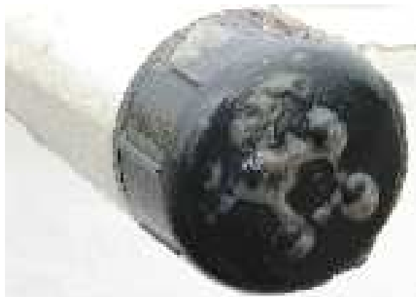
Abbildung 79: Biologischer Belag auf einer LDO-Sauerstoffsonde
